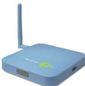
Figura 5: Këta sensorë dhe porta/modemë janë bërë nga SensorPush dhe janë një mënyrë me kosto të ulët për t'i monitoruar kushtet mjedisore.
