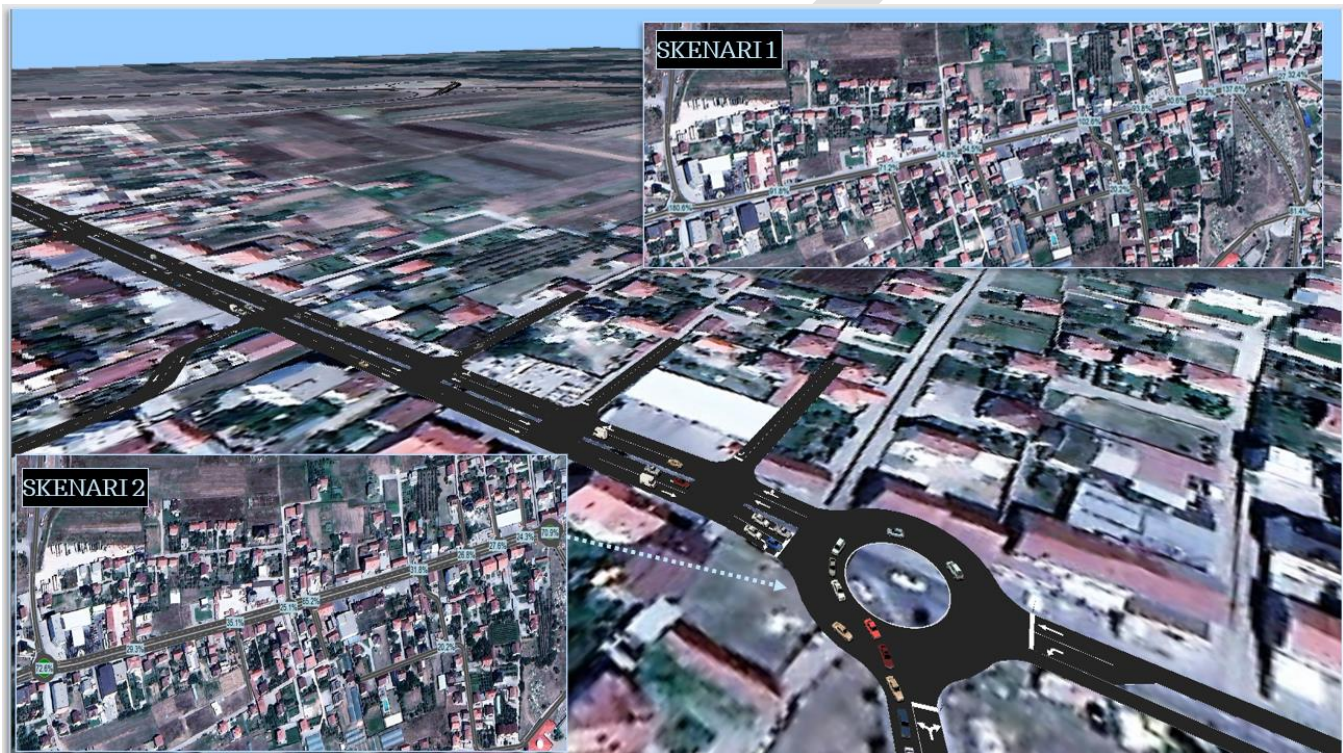
Fig.79. Parashikimi i përmirësimit të kapacitetit dhe niveli të shërbimit përgjatë rrugës “Skënderbeu” në skenarin 2 të propozuar
